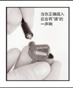
如果耳机线损坏,您可能需要把耳机线从耳机上拆卸下来,重新更换一条。为了防止耳机线意外滑落连接器上有一个卡扣。拆装时需要特别注意防止损坏耳机和连接器
