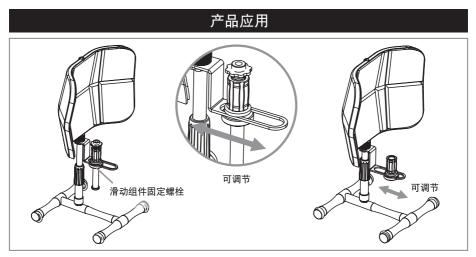
拧松滑动组件固定螺栓,沿着滑动组件(E)水平的调节麦克风的位置。直到麦克风位于合适的位置,随后锁紧滑动组件固定螺栓。
