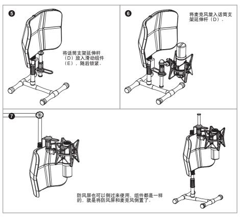
注意:当话筒支架延伸杆(D)处于最高位置或者防风屏倒置的时候,用顶块(G)在话筒支架延伸杆(D)将其固定。
