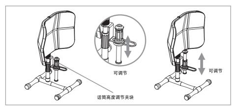
拧松话筒支架延伸杆(D)的话筒高度调节夹块,,您可以在垂直位置自由调整麦克风位置。直到麦克风位于合适的位置,随后锁紧高度调节夹块。
