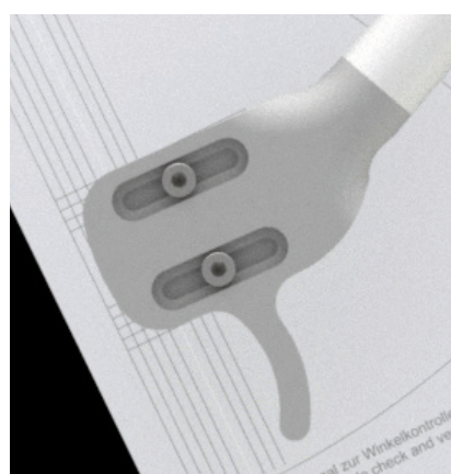
Abb. 2: Ausrichtung des Tonabnehmers
