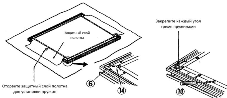
После того, как 4 угла будут соединены, добавьте по две дополнительные пружины ⑭ на угол.
