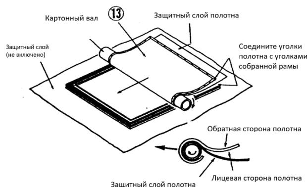
*Важно. При перемещении полотна экрана не забудьте обернуть его вокруг картонного вала, используя защитный слой.*
