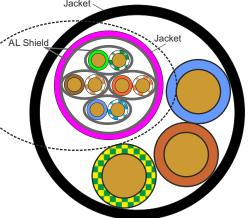
ecP\_xx: Power cable 3x2,5mm<sup>2</sup> + CAT7 4x (2 x 0,14mm<sup>2</sup>)
