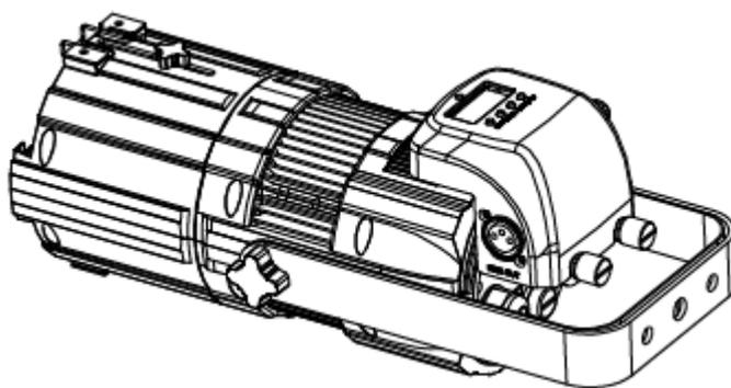
Когда на устройство не поступает сигнал DMX 512, линейное диммирование может осуществляться поворотной ручкой на ресивере. При подключении к DMX она используется для регулировки диммирования.
