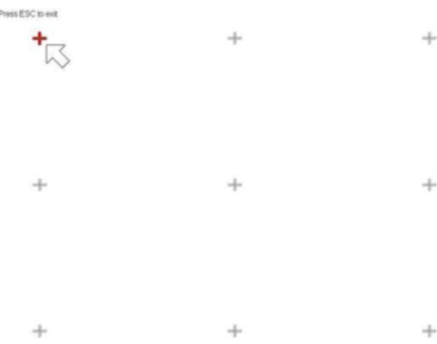
Шаг 3. Следуйте инструкциям на экране, нажмите точно в центр каждого из крестов стилусом или пальцем.
