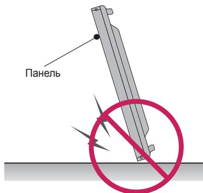
Если устройство опереть на кромку панели, нижняя часть панели может быть повреждена.
