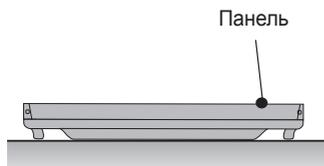
При отсутствии подкладки проверьте, чтобы пол был чистым, и осторожно положите устройство панелью вверх или вниз. Защитите панель от ударов.
