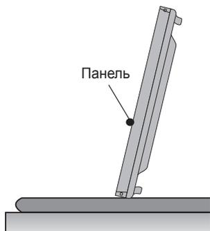
Установите устройство вертикально, держа его за обе стороны, а затем осторожно наклоните назад. Панель не должна касаться пола.
