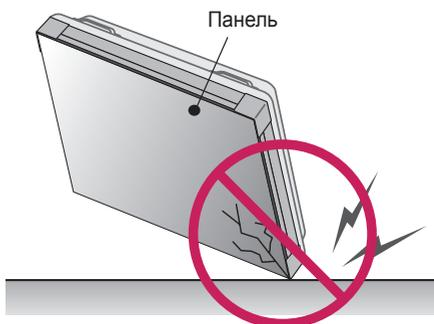
Если устройство опереть на угол панели, она может повредиться.
