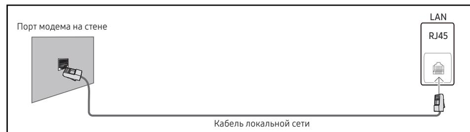
Если в вашей сети применяется динамическое распределение IP-адресов, необходимо использовать модем с поддержкой протокола DHCP. Модемы и маршрутизаторы с поддержкой DHCP автоматически пересылают в устройство IP-адрес, маску подсети, адрес шлюза и параметры DNS, необходимые для доступа к Интернету, и вам в этом случае не нужно вводить их вручную. В большинстве домашних сетей используется динамическое выделение IP-адресов.
