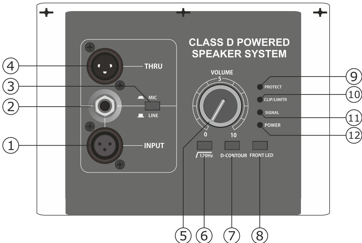
1. Балансный XLR разъем для подключения как линейных источников сигнала (например, микшерный пульт, кроссовер, эквалайзер, CD-проигрыватель, и т.д.), так и микрофонов (динамических или радиосистем)
