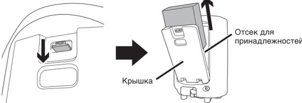
**ПРИМЕЧАНИЕ** После извлечения из коробки упакованные элементы, например кабель питания, кабели динамиков, руководство пользователя (данный буклет) и дополнительный микрофон можно хранить в отсеке для принадлежностей.
