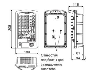
Отверстия под болты для стандартного адаптера микрофона BMS-10A (опция)
