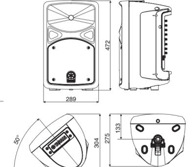
Диаметр стойки 34,8–35,2 \* При использовании стойки следует руководствоваться инструкциями производителя стойки.
