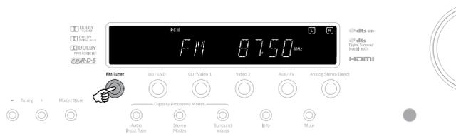
1. Нажмите кнопку «FM Tuner» (FM-радиоприемник) на передней панели ресивера или пульте ДУ, чтобы выбрать режим радиоприемника.
