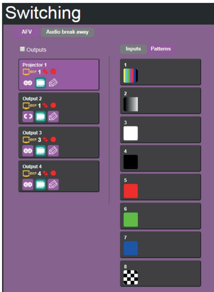
Рис. 20. Страница Switching (Переключение) – переключение испытательного изображения на выход
