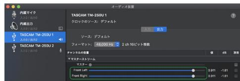
メニューバー上にあるスピーカーアイコンのスライダーでもダイレクトモニター音とMacの再生音全体のモニター音量調整が可能です。
