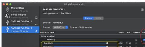
4. Pour régler le volume de l'écoute de contrôle directe et le volume de lecture de l'ordinateur, sélectionnez « TASCAM TM-250U 1 ». Cliquez sur l'onglet Sortie, et déplacez les curseurs (entourés en vert).
