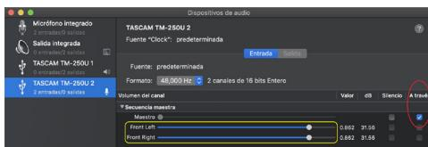
4. Para ajustar el volumen de monitorización directa y el volumen de reproducción de la computadora, seleccione "TASCAM TM-250U 1". Haga clic en la pestaña Salida y mueva los controles deslizantes (marca en verde).
