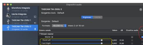
4. Per regolare il volume del monitoraggio diretto e il volume di riproduzione del computer selezionare "TASCAM TM-250U 1". Fare clic sulla scheda Uscita e spostare gli slider (segno in verde).
