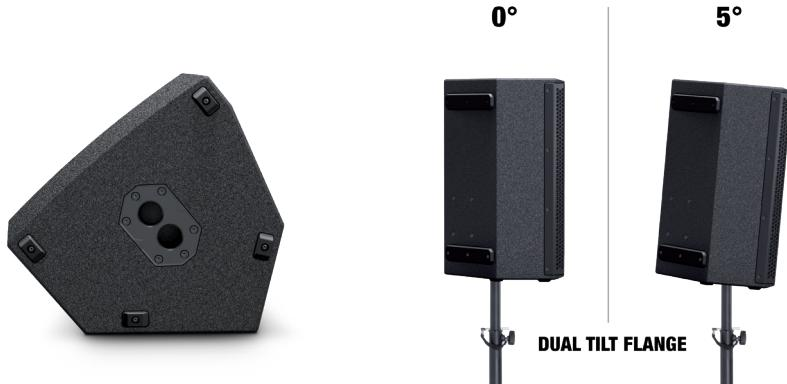
Gli altoparlanti dispongono di una flangia con un attacco per lo stativo con angolazione 0° (dietro) e con un attacco per lo stativo con angolo di inclinazione di 5° (davanti). Esempi di applicazione: utilizzare l'attacco per lo stativo con angolazione 0° per la diffusione acustica in eventi con pubblico in piedi e l'attacco per lo stativo con angolo di inclinazione 5° per la diffusione acustica in eventi con pubblico seduto.
