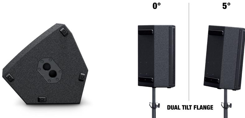
Die Lautsprecher verfügen über einen Stativflansch mit einer Stativaufnahme mit 0° Winkelung (Position hinten) und einer Stativaufnahme mit 5° Neigungswinkel (Position vorne). Anwendungsbeispiele: Verwenden Sie die Stativaufnahme mit 0° Winkelung für die Beschallung von stehendem Publikum und die Stativaufnahme mit 5° Neigungswinkel für die Beschallung von sitzendem Publikum.
