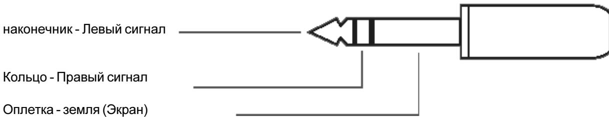
1/4`` стерео джек, используемый для точки разрыва, как перечислено
