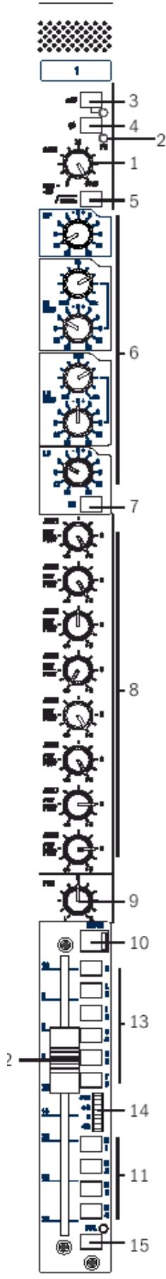
MIC GAIN (1) регулировка чувствительности как микрофонного ( организованного на разъеме XLR), так и линейного (организованного на 1/4 `` джеке) входов. Оба входа электронно симметричные и расположены на задней коммутационной панели.
