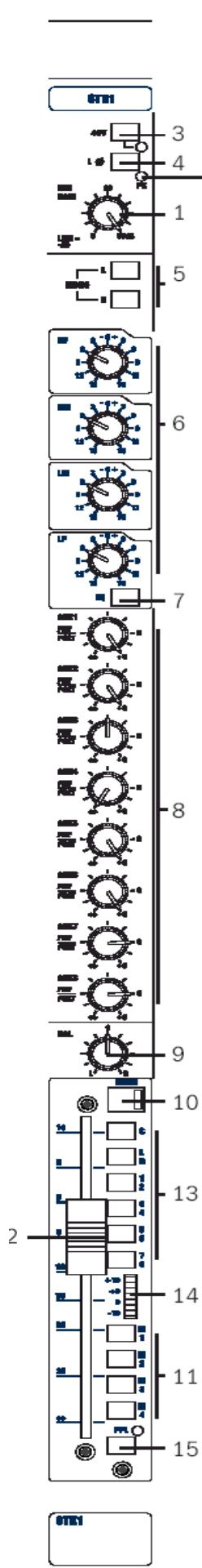
STE MIC GAIN (1) регулировка чувствительности как микрофонного ( XLR), так и линейного (1/4 `` джек) входов. Оба входа электронно симметричные и расположены на задней коммутационной панели.
