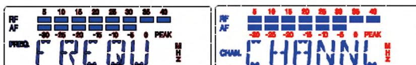
Нажмите кнопку ▲ или ▼, чтобы настроить CHANNEL и FREQU. В режиме CHANNEL на дисплее будут отображаться числа в диапазоне 0-99 или 100-199; в режиме FREQU – несущая частота радиосигнала.
