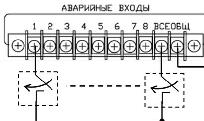
При замыкании клеммы 1-8, и клеммы ВСЕ включаются соответствующие зоны, индикаторы зон 1-8 (поз.4) светится красным цветом. Сигнал со входа ЛИН ВХ 1 поступает на усилитель мощности, при этом основной регулятор громкости ГРОМКОСТЬ (поз.7) блокируется, регулировка громкости становится возможной только при помощи регулятора ЛИН ВХ 1 (поз.16)).
