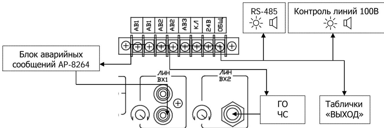
При такой схеме включения, в случае поступления на клеммы 1-8 АВАРИЙНЫЕ ВХОДЫ (поз. 20) аварийного сигнала от системы ОПС, подключаются соответствующие зоны, активируется модуль речевых сообщений, и в выбранные зоны через звуковой вход ЛИН ВХ 1, поступает записанное сообщение.
