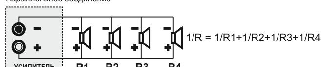
Также допустимо использование последовательно - параллельного соединения, но это не всегда удобно при монтаже кабельных трасс. Следите за тем, чтобы суммарное сопротивление акустических систем на каждом канале усилителя оставалось в диапазоне 4 - 8ohm.
