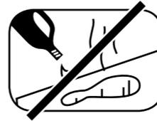
Zur Reinigung keine aggressiven, alkoholhaltigen oder scheuernden Mittel einsetzen
