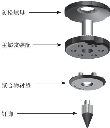
支架完全组装用于地毯地板。您只需要将其安装到机箱底部。支架的安装可以通过将螺钉完全接合位于机箱下面的4组螺纹衬套来完成。如果您的地毯较厚，将环保型聚合物衬垫从支架移除，以确保钉脚穿过地毯与地面接合。小心翼翼地将机箱正确立起。将机箱置于您所期望的位置，并检查其各个侧面保持水平。如果稍微不达水平状态，在最低点拧开钉脚重新检查。
