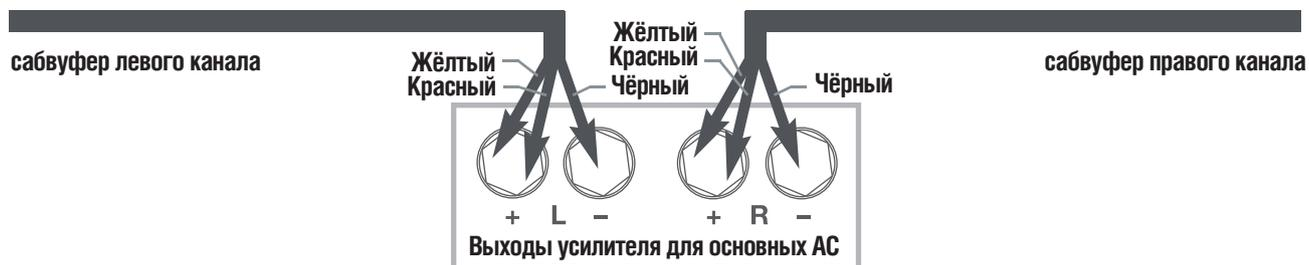
Для подключения системы REL в качестве сабвуфера центрального канала, соедините вместе красный и жёлтый кабели сабвуфера и подключите их к красной (положительной) клемме центрального канала усилителя, а чёрный кабель – к чёрной (отрицательной) клемме.
