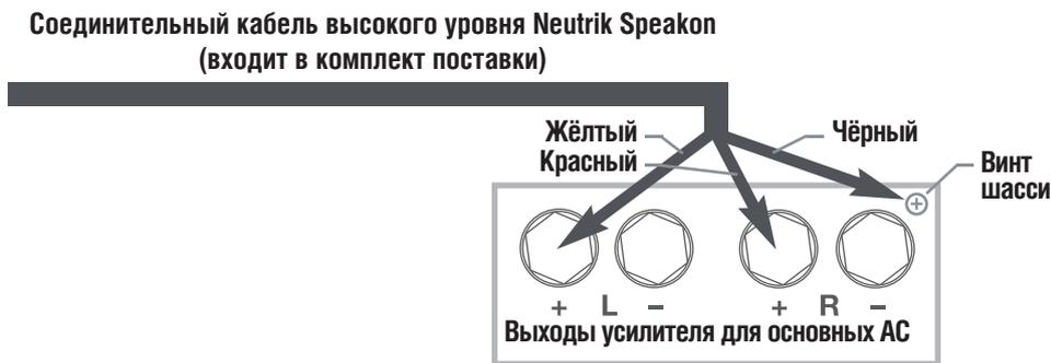
**Примечание:** конструкция сабвуферов REL серии T позволяет подключать их к цифровым усилителям класса D. При подключении к усилителю класса D следуйте приведённой выше схеме для подключения к дифференциальным усилителям.
