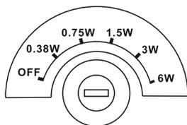
Каждое положение аттенюатора соответствует определенной мощности - 0,38 / 0,75 / 1,5 / 3 / 6W в 100V режиме. Шестое положение аттенюатора отключает громкоговоритель. Благодаря этому данную модель удобно использовать например в отдельных офисных кабинетах, учебных классах, гостиничных номерах, административных помещениях и так далее.
