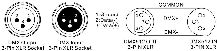
Für Anlagen mit sehr langen DMX-Kabelwegen oder hohen elektrischen Störeinflüssen, wie zum Beispiel in einer Diskothek, ist es empfehlenswert, einen DMX-Terminator zu verwenden. Der DMX-Abschlusswiderstand wird in einem XLR-Stecker als 120  $\Omega$  Widerstand zwischen Pin 2 und 3 ausgeführt der in die letzte Ausgangsbuchse der DMX-Linie gesteckt wird.
