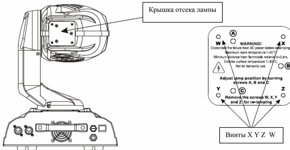
Откройте 4 винта крышки отсека лампы (см. рисунок). Выньте узел целиком, а затем извлеките старую лампу из патрона.
