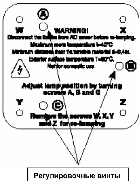
Лампа, как правило, отрегулирована на заводе. Однако, из-за легких различий в лампах, может потребоваться дополнительная регулировка.
