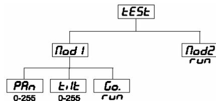
Программа Mod1 подходит для показа функций прибора на стене, потолке, полу – в этой программе луч прибора не двигается. Программа Mod2 показывает все возможности прибора, включая движение луча, что позволяет полнее показать возможности прибора.
