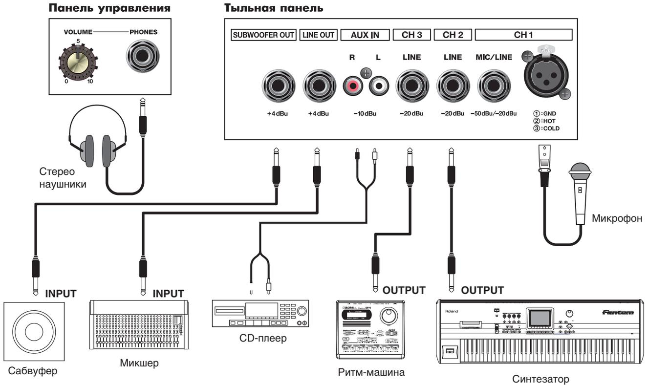
На рисунке приведен пример коммутации, при которой используются все возможности микширования и мониторинга КС-60.
