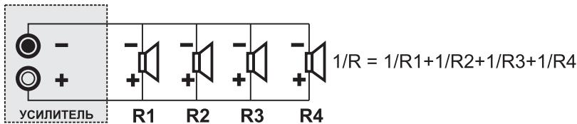
Также допустимо использование последовательно - параллельного соединения, но это не всегда удобно при монтаже кабельных трасс.
