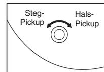
Wenn Sie den Regler im Uhrzeigersinn drehen, wird der Hals-Pickup lauter und der Steg-Pickup wird leiser. Wenn Sie den Regler gegen den Uhrzeigersinn drehen, wird der Hals-Pickup leiser und der Steg-Pickup wird lauter.
