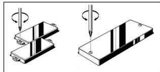
\*Bei Instrumenten mit einstellbaren Polstücken kann die Ausgangssignalstärke jeder Saite eingestellt werden.
