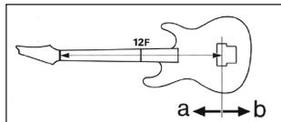
て、それぞれの弦の12フレットを押さえた時の音と、12フレット上でのハーモニクス音がおおよそ等しいかどうかを判断する方法が一般的です。ハーモニクス音を基準として、フレット音が低い場合はブリッジサドルを前方（ヘッド側）へ移動させて弦長を短くします。逆にフレット音が高い場合は、ブリッジサドルを後方（ヘッド側と逆方向）へ移動させて弦長を長くします。
