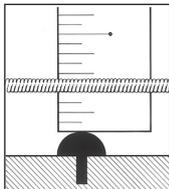
Um die Saitenlage (Action) zu erhöhen oder zu verringern, stecken Sie einen passenden Innensechskantschlüssel in die Schraube des Saitenreiters. Zum Erhöhen des Reiters muss der Schlüssel im Uhrzeigersinn, zum Absenken gegen den Uhrzeigersinn gedreht werden.
