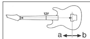
\*Remarque : le déplacement des sillets peut provoquer la rupture des cordes. Pour éviter cela, détendez toujours les cordes avant d'effectuer un tel réglage.
